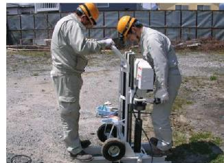
簡易ボーリングマシンを使った表層土壤試料採取
