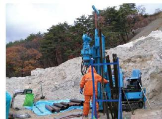
打撃式ボーリングマシンを用いた深層土壤試料採取
